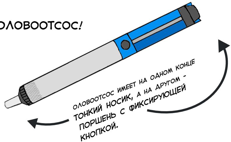
ВНУТРИ РАСПОЛОЖЕНА ПРУЖИНА, КОТОРАЯ ПРИ НАЖАТИИ НА ПОРШЕНЬ РАСТЯГИВАЕТСЯ, но благодаря КНОПКЕ-ФИКСАТОРУ не возвращается в исходное положение.
